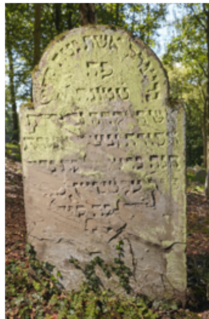
Abb. 12: Grabmal aus feinkörnigem, beige-braunem Sandstein. Schalenbildung führt über kurz oder lang zu einem Verlust der Inschrift. Foto: Peter Kunz
