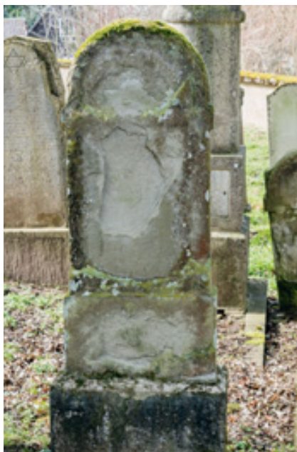
Abb. 13: Grabmale aus feinkörnigen Sandsteinen, wie z.B. der grünliche Schiffsandstein, zeigen häufig intensive Schalenbildung und großflächiges Abplatzen. Foto: Christoph Bender
